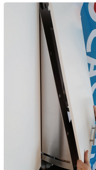
3. Haka av fronten: fäll ut fronten lite, skruva loss de två svarta rattarna, lyft upp och haka av.
